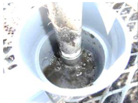
図 3. 落下水流による空気移送の状況
