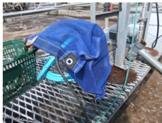
図3. 水中への投入前にネット袋に挿入した測定液採取用水中ポンプ
